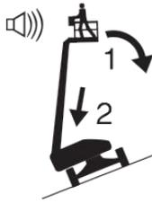
Si suena la alarma de inclinación en la plataforma en ascenso:
