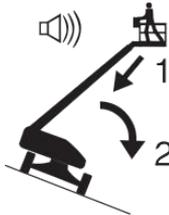
Si suena la alarma de inclinación en la plataforma en descenso:
