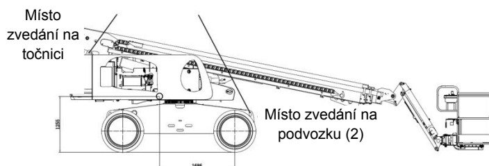
Obrázek 10-5 Schéma uchycení pro zvedání stroje
