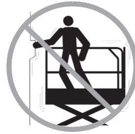
6) Wenn die Maschine im Freien verwendet wird, heben Sie die Bühne nicht an, wenn die Windgeschwindigkeit über 12,5 m/s liegt. Wenn die Windgeschwindigkeit nach dem Anheben der Bühne den Grenzwert überschreitet, senken Sie die Bühne sofort ab und stoppen Sie den gesamten Maschinenbetrieb.
