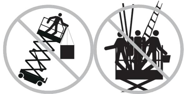
13) Stellen Sie keine Leitern oder Gerüste auf die Bühne oder gegen ein Bauteil der Maschine.
