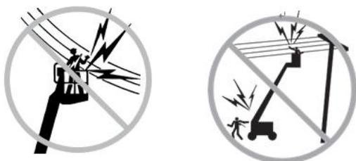
Si prega di mantenere un'adeguata distanza di sicurezza dal cablaggio elettrico, dalla fonte di alimentazione e dalle apparecchiature elettriche in conformità alle leggi e ai regolamenti applicabili e alle istruzioni della seguente
