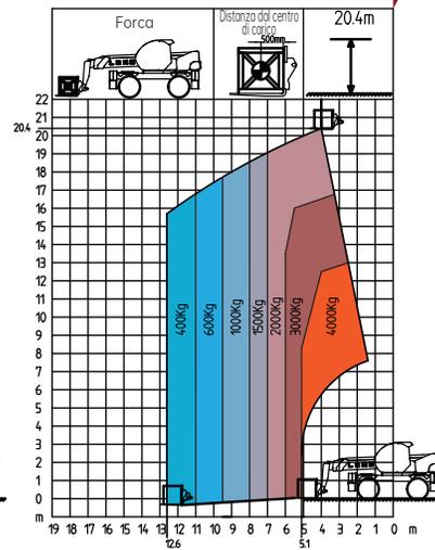
Stabilizzatori idraulici non aperti-rotativi
