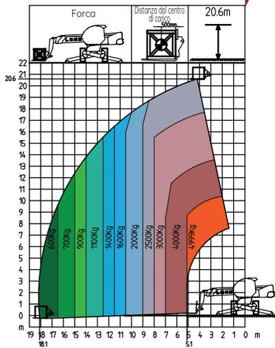
Stabilizzatori idraulici non aperti
